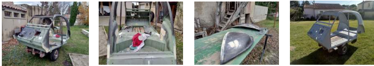
Pose de mastic sur la caisse et ponçage
